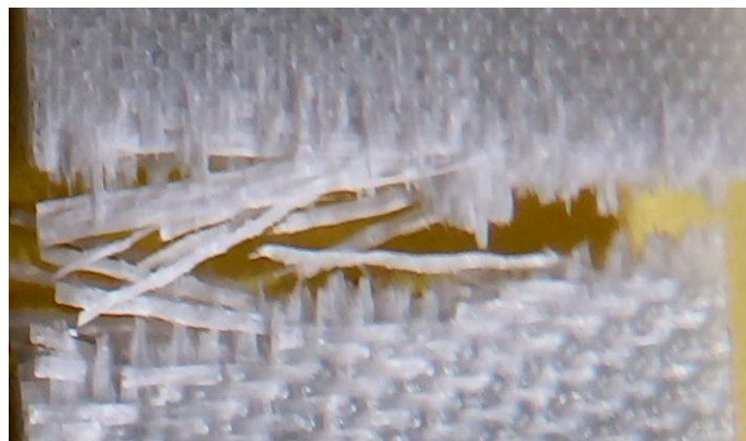
Figure 21. Faciès de rupture de la face longitudinale du stratifié V/E.
