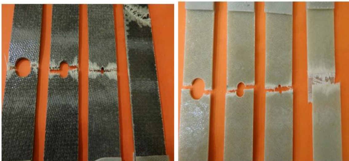
Figure 61. Eprouvettes perforées rompues en MCH et V/E subissant un traitement de vieillissement.
