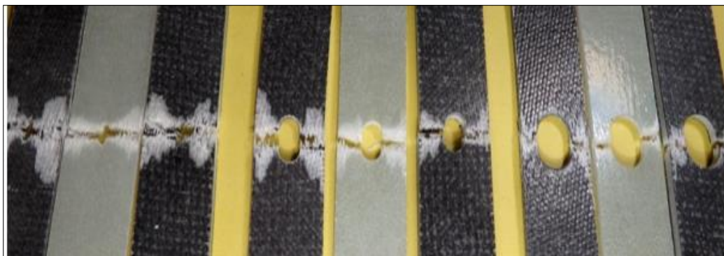
Figure 44. Éprouvettes perforées des différents stratifiés composés de huit plis après essai de traction.
