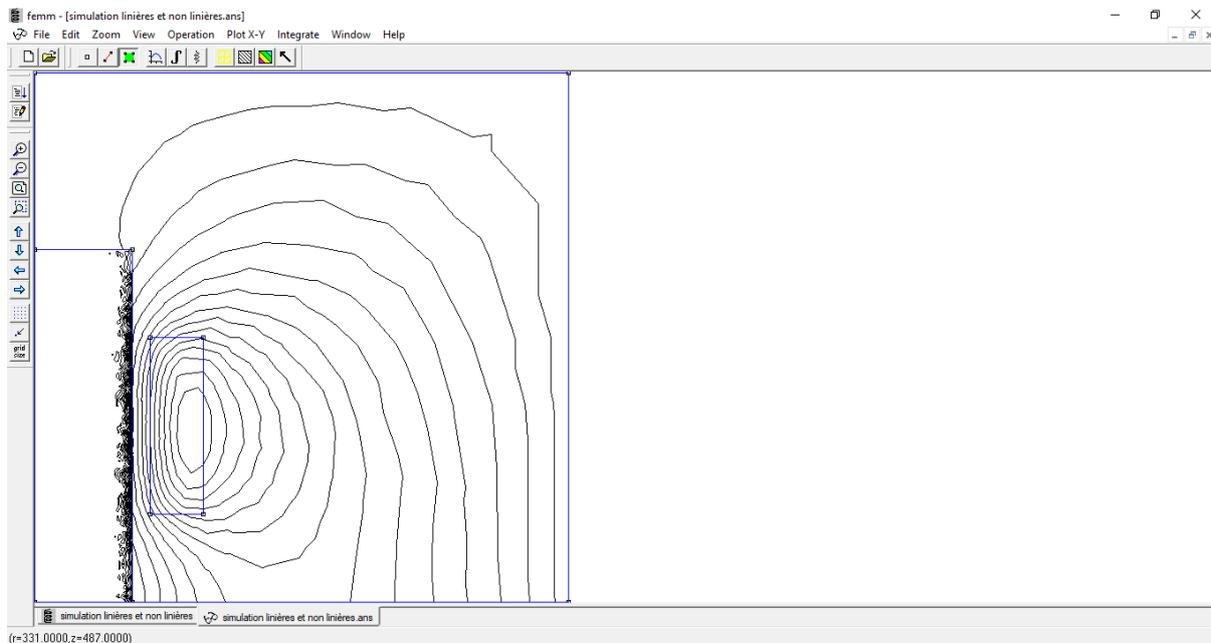
**Figure IV.47 :** La répartition des lignes du flux magnétique pour une fréquence de 500 Hz tracée par logiciel « FEMM».
