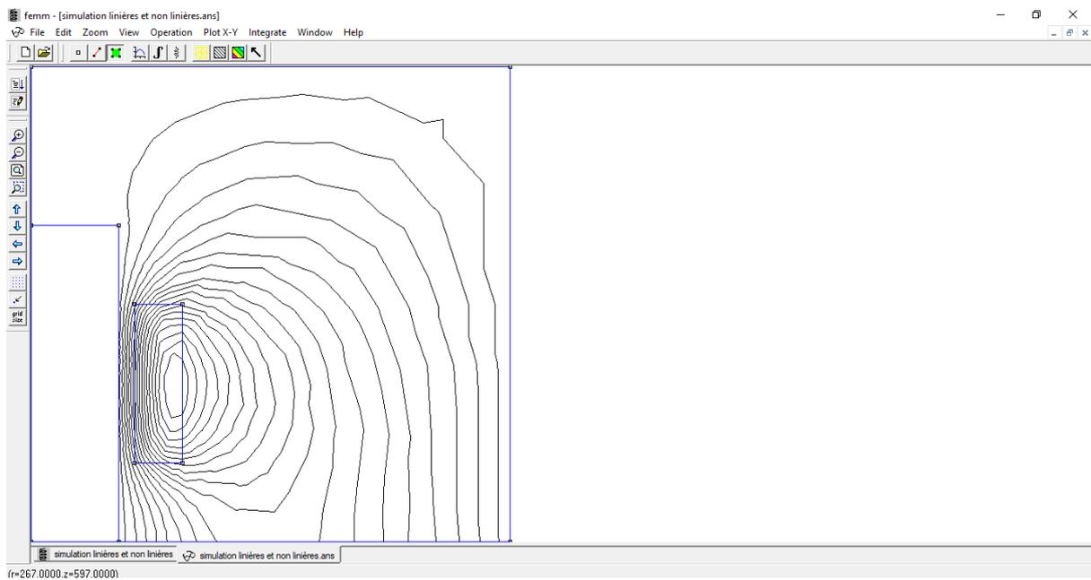
**Figure IV.51:** La répartition des lignes du flux magnétique pour une fréquence de 75 KHz tracée par logiciel « FEMM».
