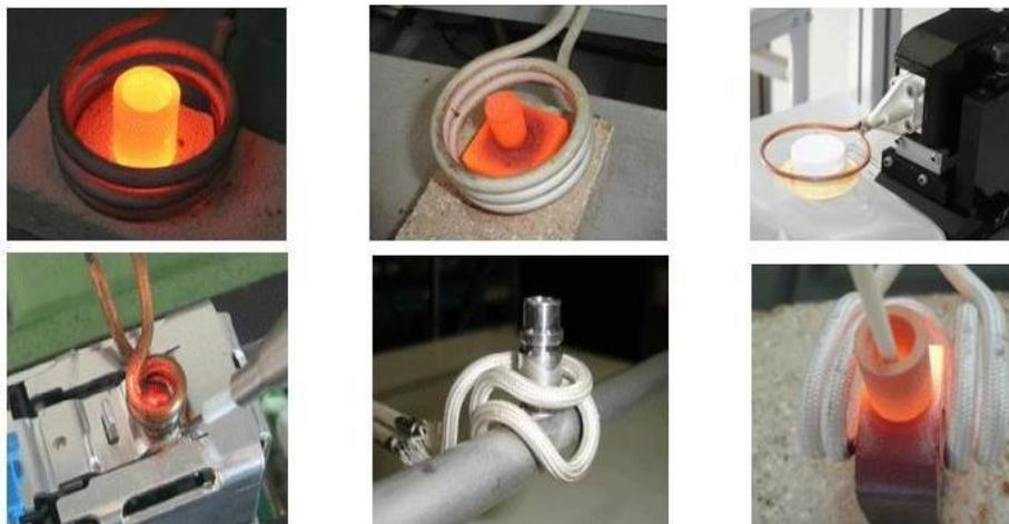
Figure (1.3) : chauffage avec des inducteurs différents
