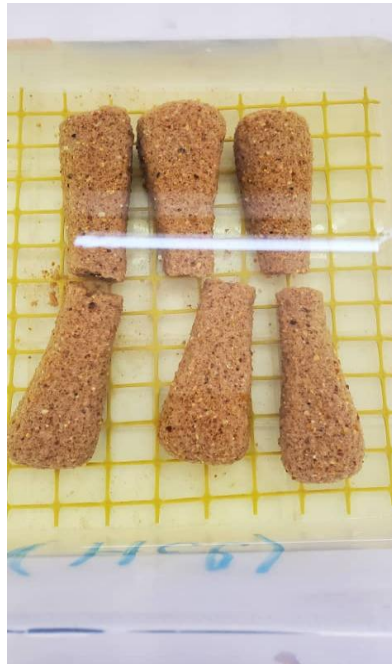
Figure 46: perte de masse et changement de forme et de couleur du mortier (HCl)
