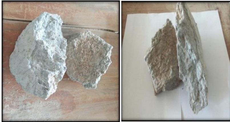
Figure 12 Aspect de la perlite sous forme de roche [OULD MOUSSA. M. T]
