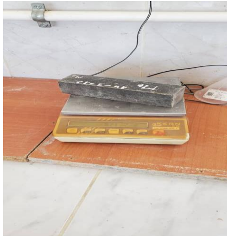
Figure 24 Prise de poids des éprouvettes avant de les mettre dans les solutions
