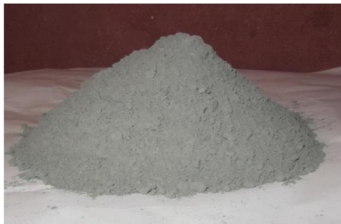
Figure 14: la poudre de perlite après le broyage et tamisage
