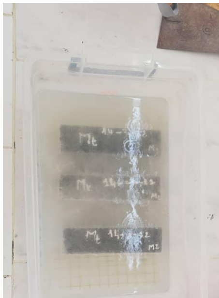
Figure 21 Bac des mortiers témoins
