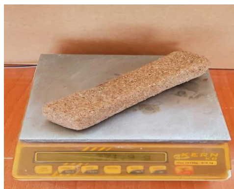
Figure 47 Fragilité du mortier témoin après 9 semaines dans la solution
