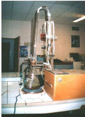
*Figure 19: Montage d'hydrodistillation employé pour l'extraction d'huile essentielle.*
