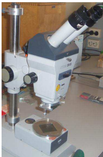
Figure II.3. Microscope pour le choix du monocristal
