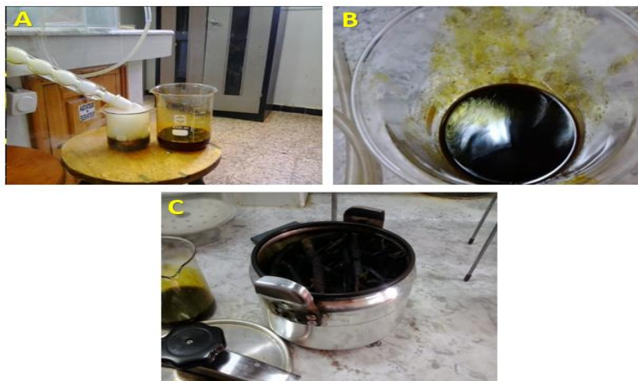
Figure 34 : Résultats de l'extraction par pyrolyse, A : Phases huileuse et goudroneuse, B : Aspect du goudron, C : Etat du bois après pyrolyse.
