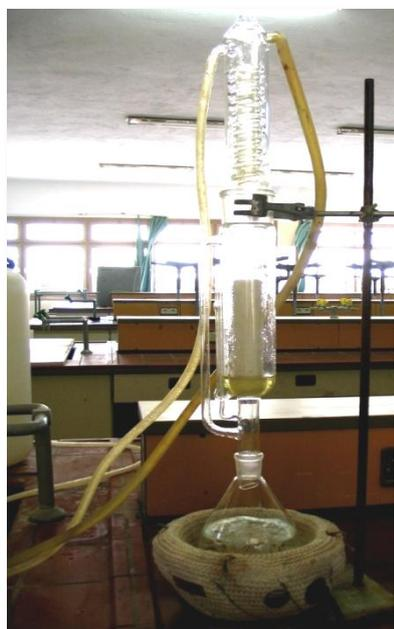
**Figure 20** : L'extracteur soxhlet
