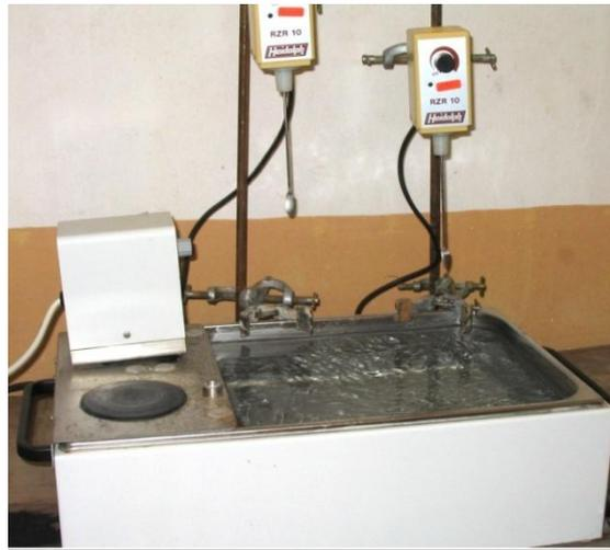
**Figure 16** : modèle de cristallisation (Bain Marie thermostaté + Agitateur)
