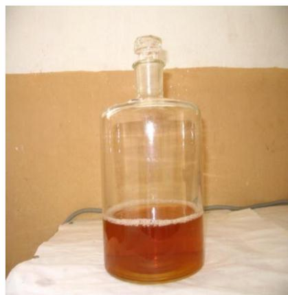
**Figure 21** : Extrait issu de soxhlet après filtration
