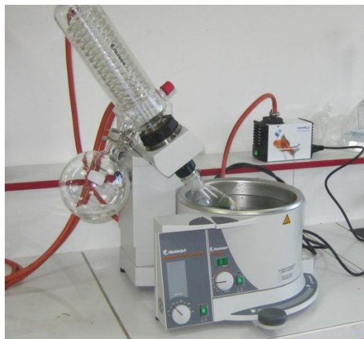
Photo 2: Rota vapeur utilisé pour le séchage des filtrats après l'extraction.
