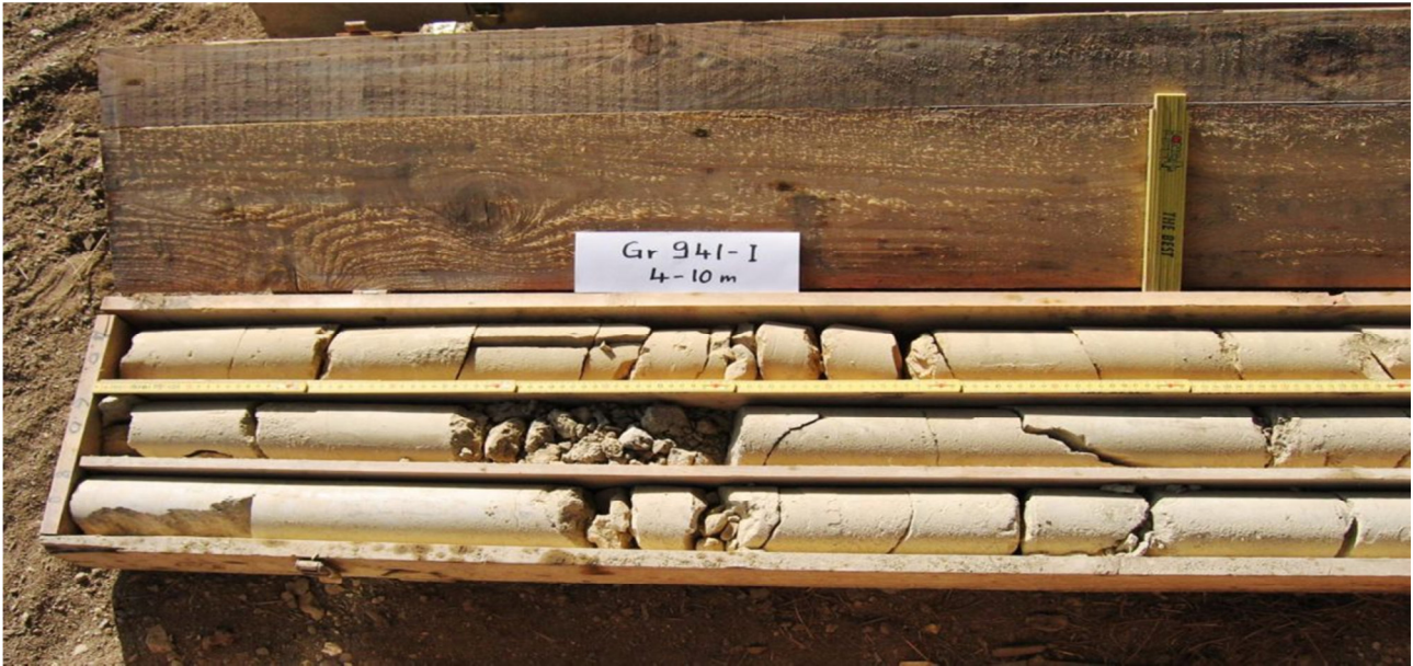
Figure 3: caisse de carottes prélevées après un sondage (Référence : LTPO).
