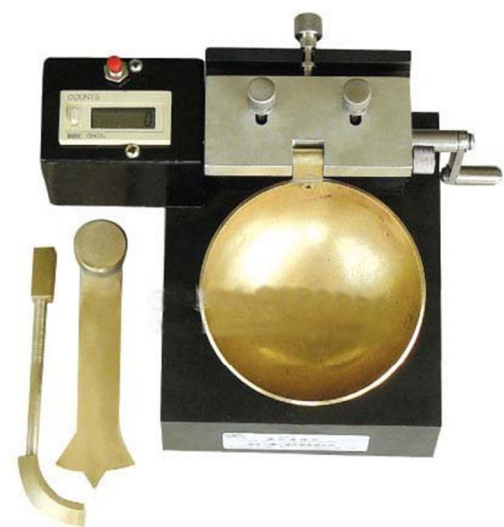
Figure 12: appareil de Casagrande (référence : LTPO)
