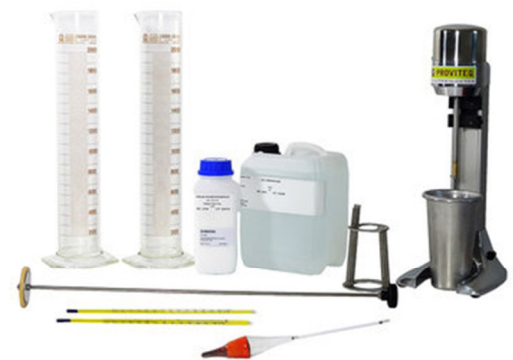
Figure 8: matériels de l'essai sédimentométrique (référence LTPO)
