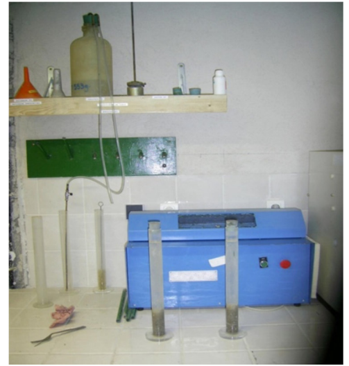
Figure 9: matériels de l'essai d'équivalent de sable (référence :LTPO)
