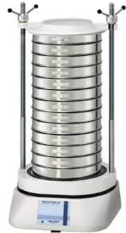
Figure 7: série des tamis sur une table vibrante (référence : LTPO)
