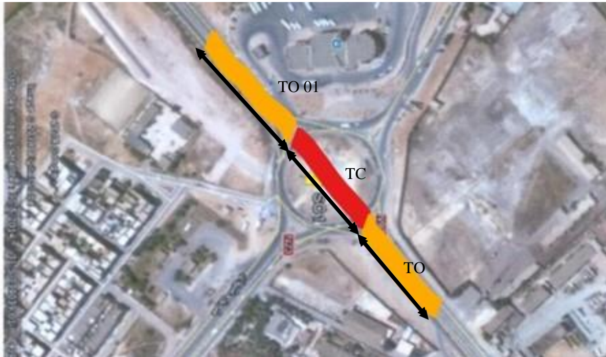
Figure I.6 : Les trois (3) sections de la trémie
