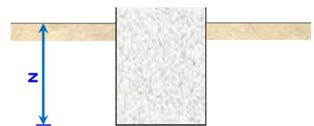
Fig.VIII.5. : Encrage de la structure.
