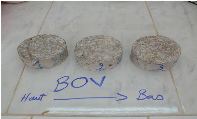
**Figure II.5 Observation de la répartition des granulats pour un béton ordinaire avec Vase BOV.**
