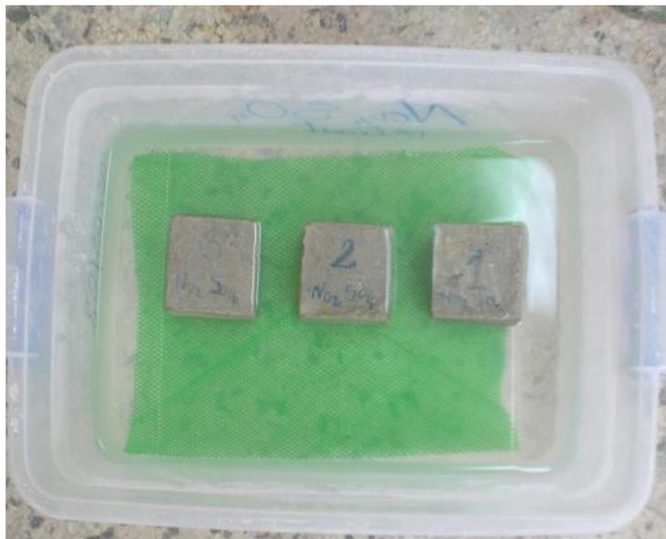
**Figure III.2.1. Immersion des éprouvettes en solution de 5% Na<sub>2</sub>SO<sub>4</sub>.**
