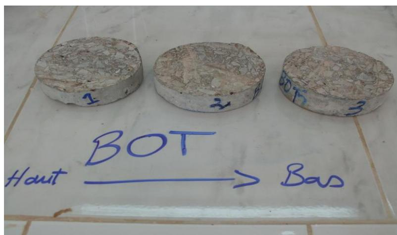
**Figure II.4 Observation de la répartition des granulats pour un béton ordinaire Témoin BOT.**
