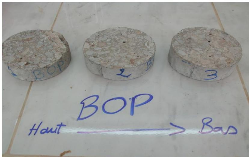
**Figure II.6 Observation de la répartition des granulats pour un béton ordinaire avec Pouzzolane BOP.**
