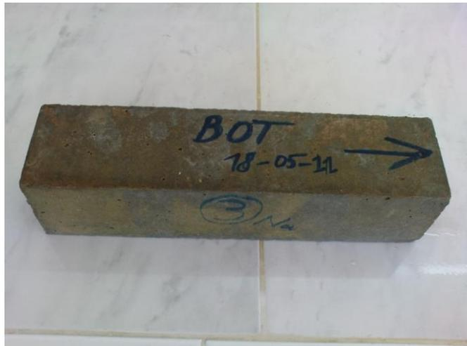
Figure III.4.6. Etat des éprouvettes des bétons témoins après 90 jours d'immersion dans la solution de sulfate de sodium ( $\text{Na}_2\text{SO}_4$ )
