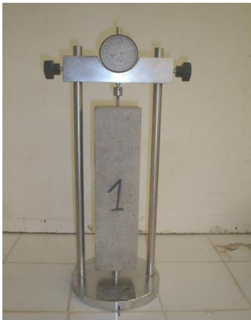
**Figure II.3. Appareil de retrait.**
