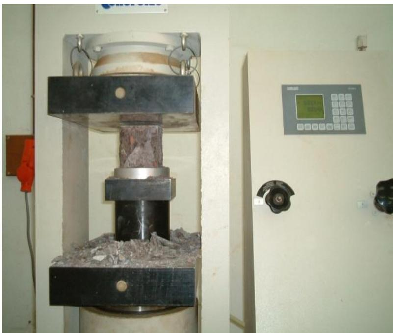
**Figure II.2 Essai d'écrasement de l'éprouvette 70x70x70 mm<sup>3</sup>**
