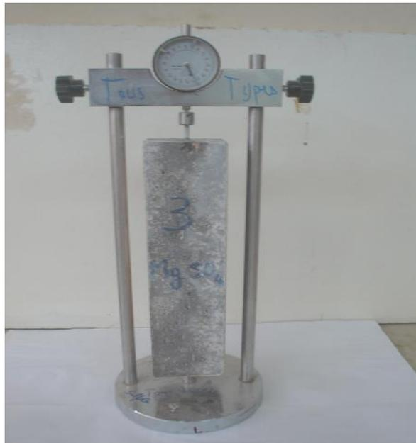
**Figure II.5 Rétractomètre pour la mesure du gonflement sur une éprouvette de béton (7x7x28) cm<sup>3</sup>.**
