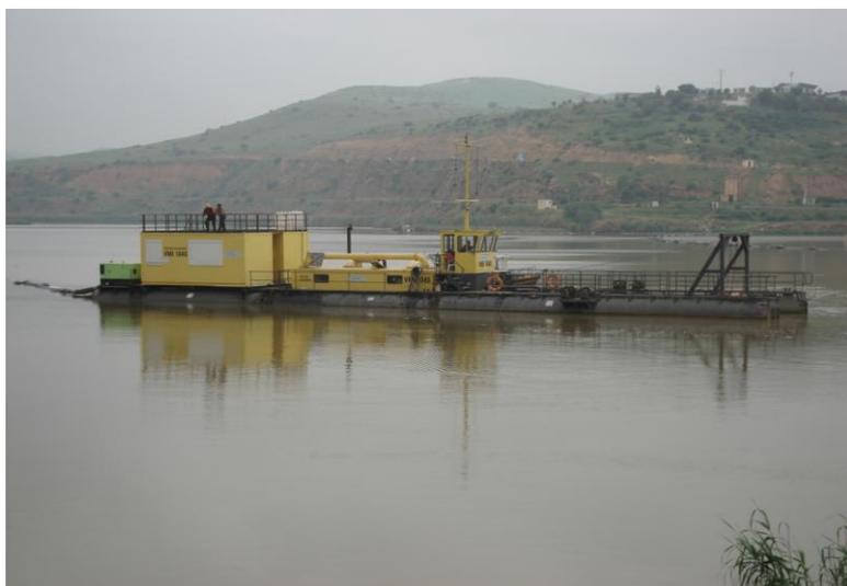
**Figure I.3.a.** Dragueuse suceuse. [5].
