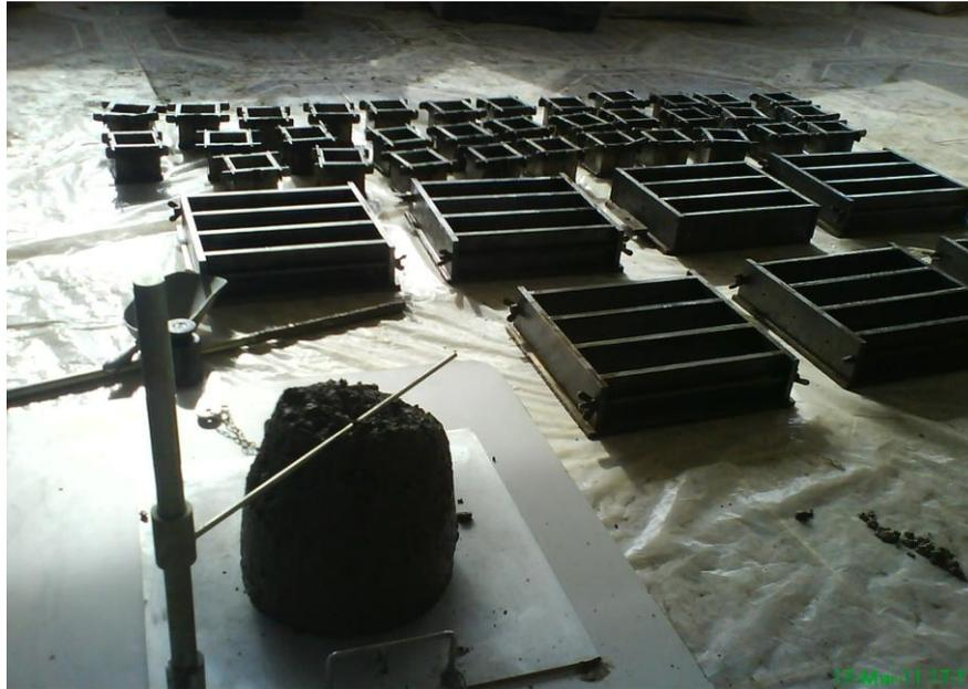
**Figure I.3. L'affaissement du béton au cône d'Abrams.**
