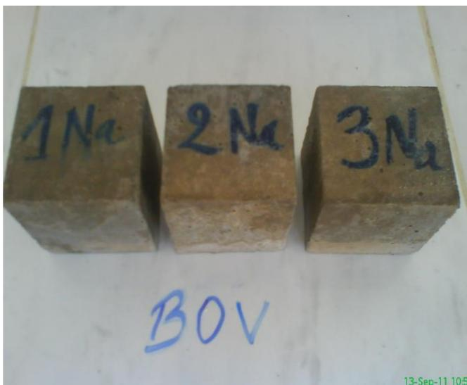
**Figure III.2.8. Echantillons des bétons ordinaires avec vase immergés dans la solution  $Na_2SO_4$**
