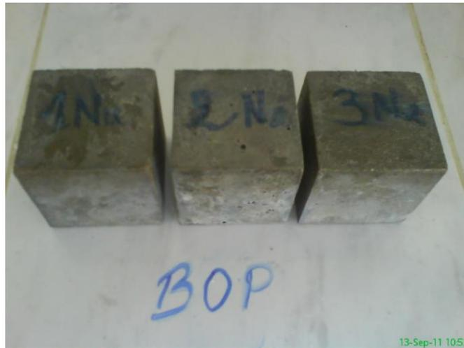
**Figure III.2.9. Echantillons des bétons ordinaires avec pouzzolane immergés dans la solution  $\text{Na}_2\text{SO}_4$**
