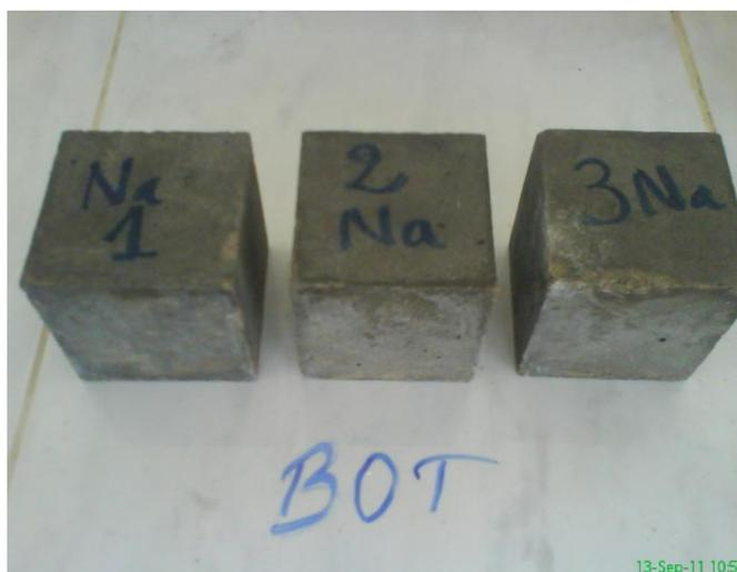
**Figure III.2.7. Echantillons des bétons ordinaires immergés dans la solution  $Na_2SO_4$**
