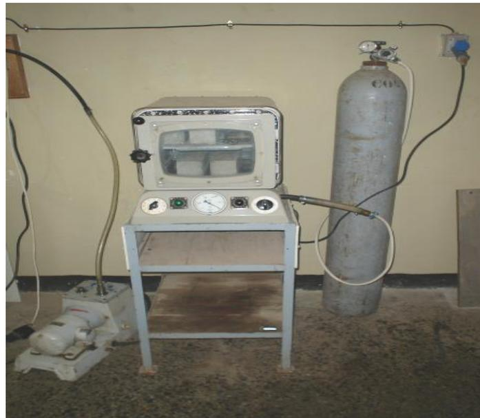
**Figure II.6. Enceinte de carbonatation accélérée**
