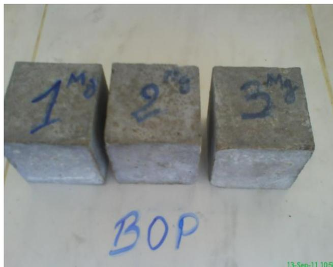
**Figure III.2.12 Echantillons des bétons ordinaires avec pouzzolane immergés dans la solution  $MgSO_4$**
