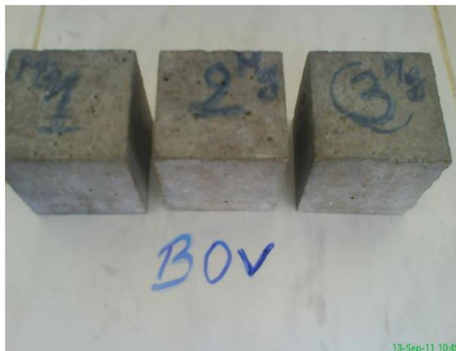
**Figure III.2.11. Echantillons des bétons ordinaires avec vase immergés dans la solution  $\text{MgSO}_4$**
