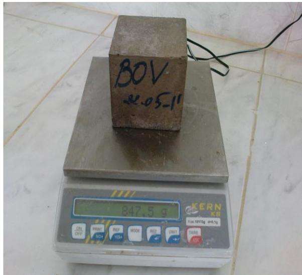
**Figure II.5 Pesée des échantillons de béton.**
