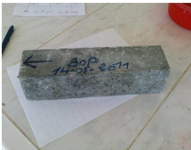
**Figure III.4.11. Etat des éprouvettes des bétons avec pouzzolane après 90 jours d'immersion dans la solution de sulfate de magnésium ( $MgSO_4$ )**
