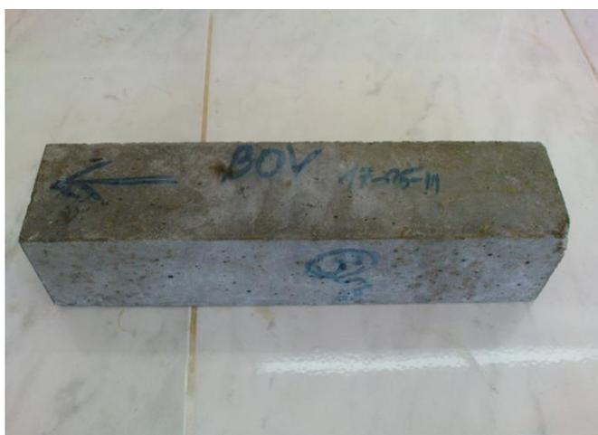
**Figure III.4.10. Etat des éprouvettes des bétons avec vase après 90 jours d'immersion dans la solution de sulfate de magnésium ( $MgSO_4$ )**
