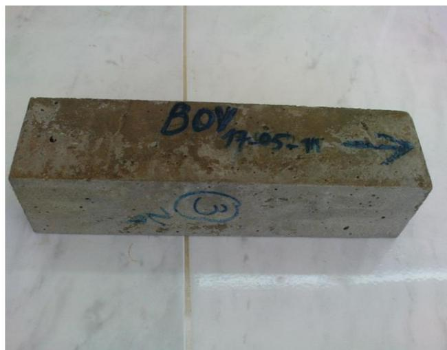
Figure III.4.7. Etat des éprouvettes des bétons avec vase après 90 jours d'immersion dans la solution de sulfate de sodium ( $\text{Na}_2\text{SO}_4$ )
