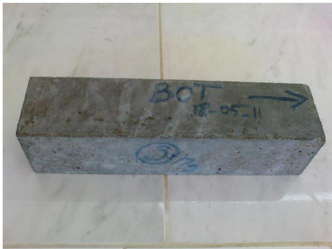
**Figure III.4.9. Etat des éprouvettes des bétons témoins après 90 jours d'immersion dans la solution de sulfate de magnésium ( $MgSO_4$ )**
