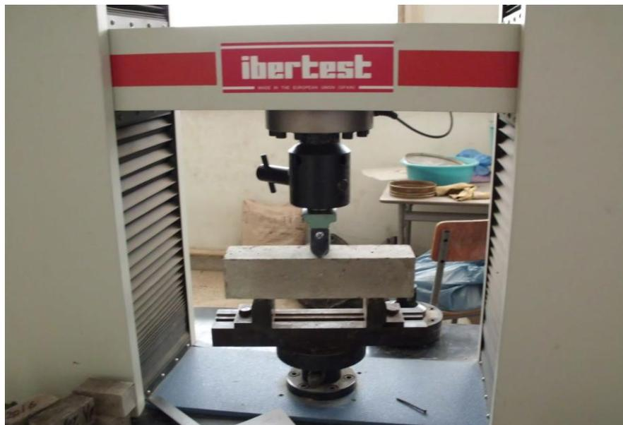
Figure II.1. Appareil de la résistance à la traction par flexion.
