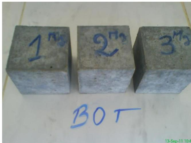
**Figure III.2.10. Echantillons des bétons ordinaires immergés dans la solution  $\text{MgSO}_4$**
