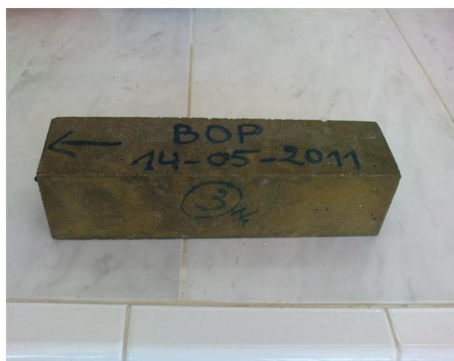
Figure III.4.8. Etat des éprouvettes des bétons avec pouzzolane après 90 jours d'immersion dans la solution de sulfate de sodium ( $\text{Na}_2\text{SO}_4$ )
