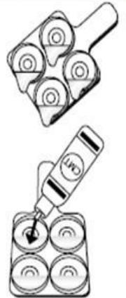
2) Ajoutez un volume de réactif équivalent à la quantité de lait en remplissant le godet jusqu'au cercle central.
