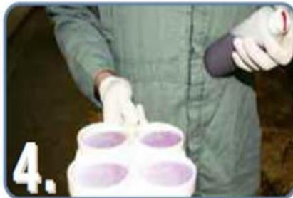
4. Mélangez bien le réactif et le lait par un mouvement circulaire pendant 10 à 30 secondes.
