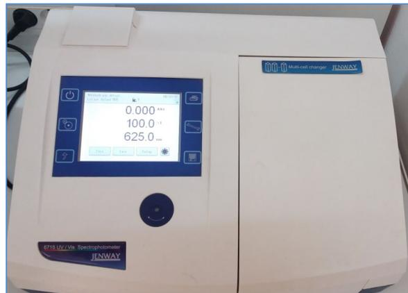
Figure 13 : Spectrophotomètre JENWAY réglé à longueur d'onde 625 n.m
