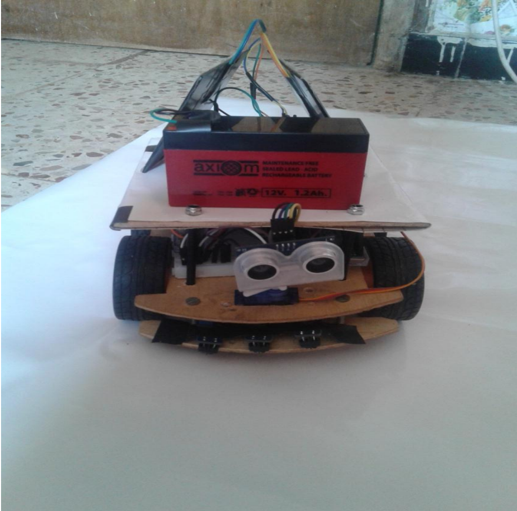
Figure IV. Montage final du robot avec les panneaux solaires
