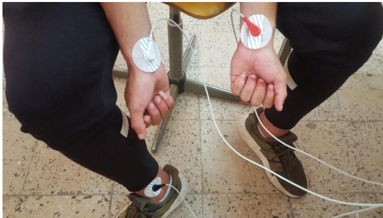
Figure II.11 : Répartition des électrodes ; bras droit, bras gauche et pied droit.
