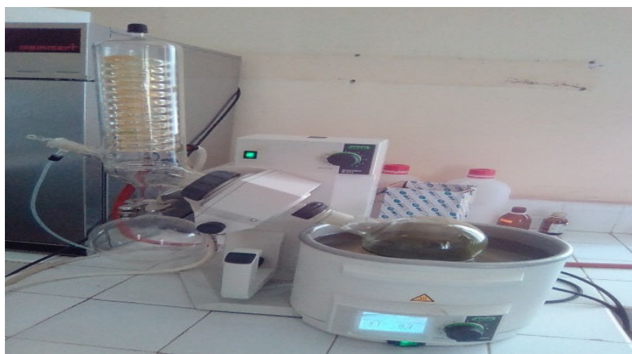
Figure 10. Rotavapor (évaporation du solvant sous vide)
