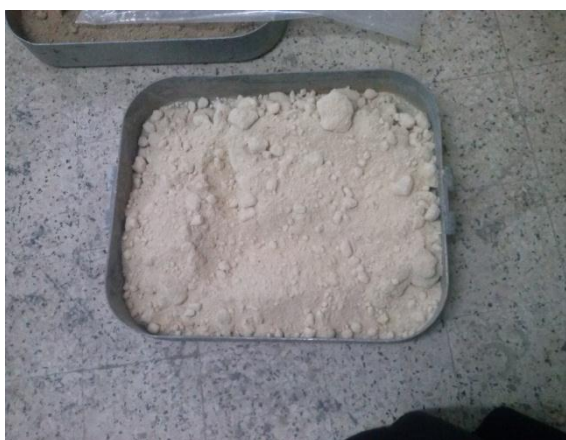
Figure V.23 : Teneur en eau par étuvage CF
