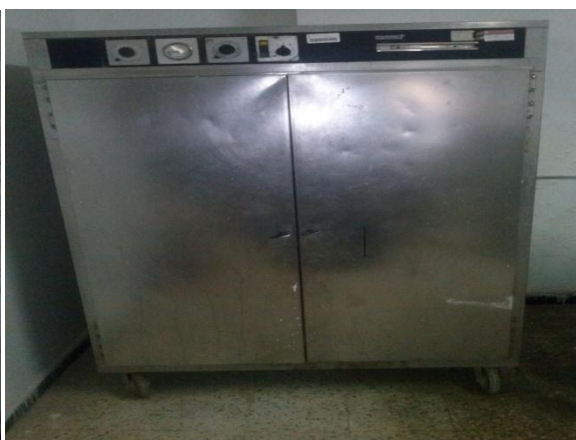
Figure V.23 : Teneur en eau par étuvage CF
