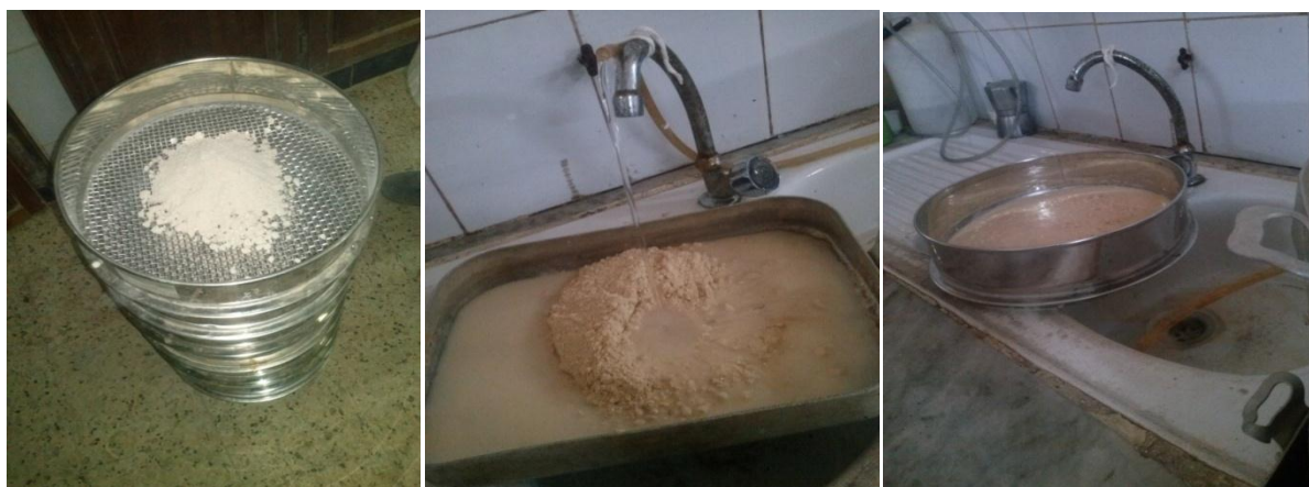
Figure V.25. Granulométrie après lavage CF
