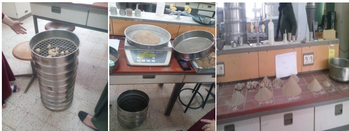
Figure V.15 : Granulométrie avant lavage
