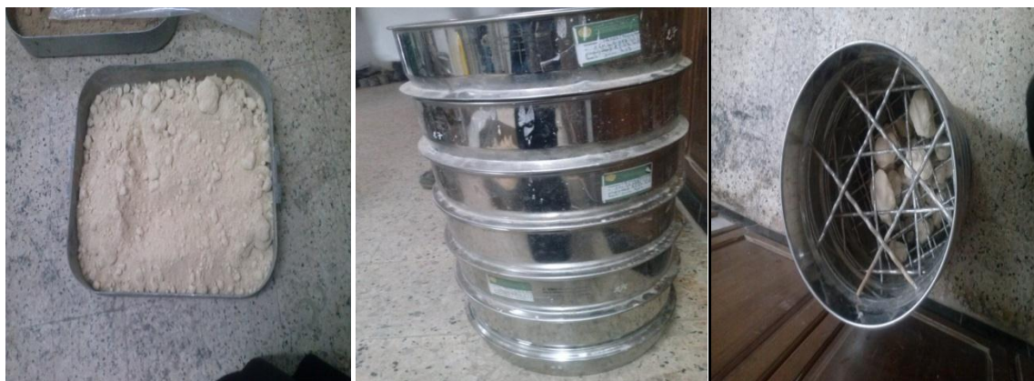
Figure V.24. Granulométrie avant lavage CF
