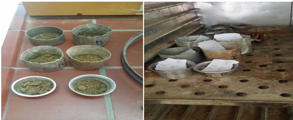
Figure V.10 : Teneur en eau par étuvege
