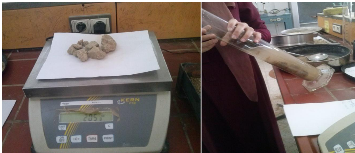
Figure V.13 : masse volumique absolue des cailloux
