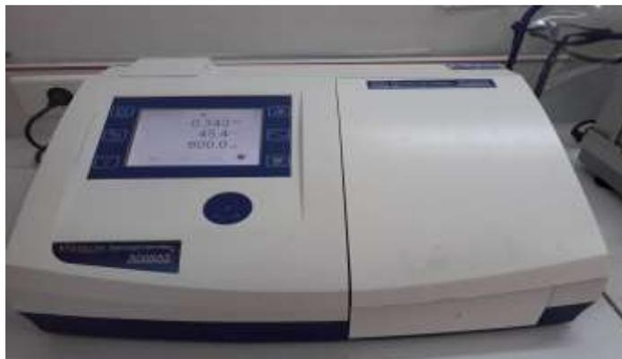
**Figure 10** : Un spectrophotomètre (**JENWAY 6715/UV, vis**).
