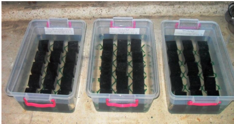
Figure II.24: Immersion totale des échantillons des composites LMEPVCs dans une solution de 5% NaCl jusqu'au 7, 28 et 91 jours.
