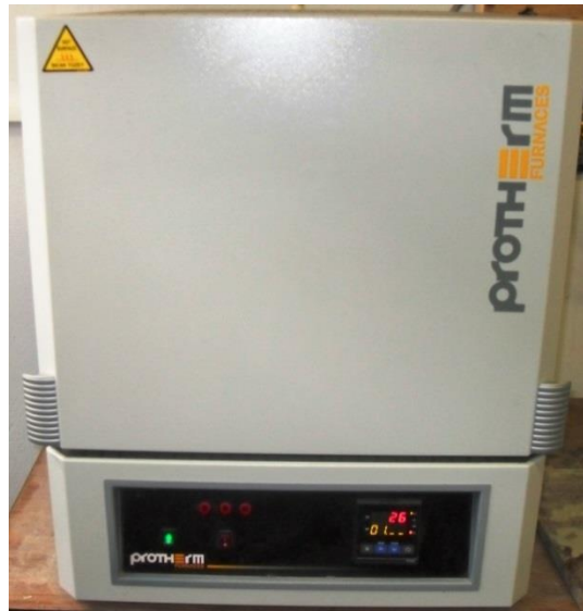
Figure II.16 : Four électrique, (Laboratoire LABMAT) à l'ENP d'ORAN.
