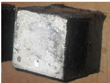
Figure II.25: Echantillon avant l'immersion dans la solution NaCl à 5%.
