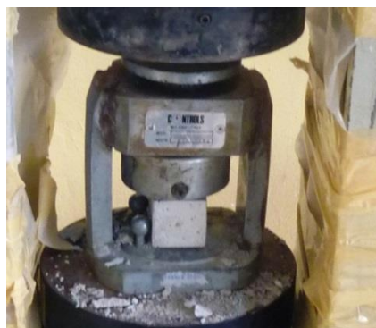
Figure II.11 : Dispositif pour l'essai de la résistance à la compression.
