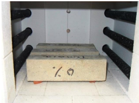
Figure II.17 : Disposition des éprouvettes dans le four.
