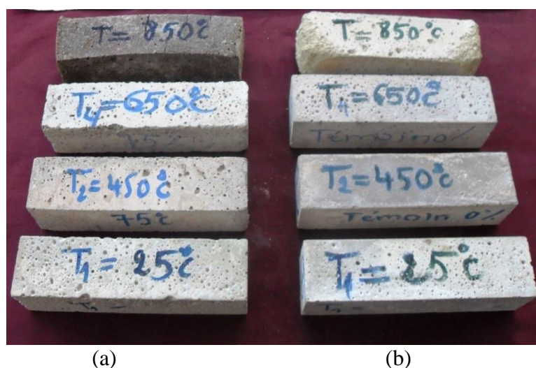
Figure IV. 10 : Etat de la surface des éprouvettes des mortiers : (a) LMEPVC75 ; (b) NWM à différentes températures d'exposition.
