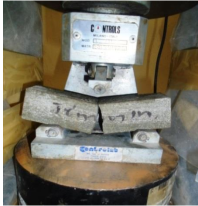
Figure II.10 : Dispositif pour l'essai de la résistance à la flexion.
