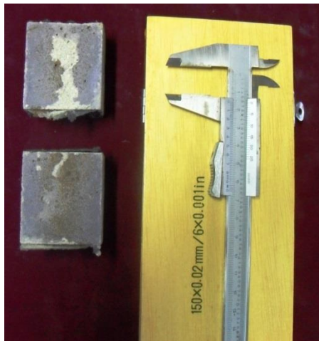
Figure II.27 : Section transversale d'éprouvette après avoir employé 0.1 N de l'essai d'indicateur de nitrate d'argent.
