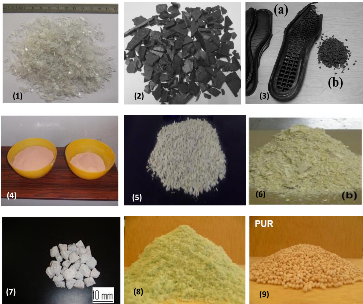
Figure I.4 : Certains types des matières recyclables d'origine industrielle utilisées dans les applications en génie civil : (1) Polyéthylène téréphtalate (PET) [37] (2) Déchets des pièces plastiques électroniques [38] (3) Chaussures en caoutchouc [39] (4) Poudre de liège [29] (5) Agrégat de PVC [40] (6) Les déchets de bois [25] (7) Mousse de verre [41] (8) Polystyrène expansé (PSE – bille découpée) [42] (9) Mousse de polyuréthane extrudé rigide (PUR) [42].
