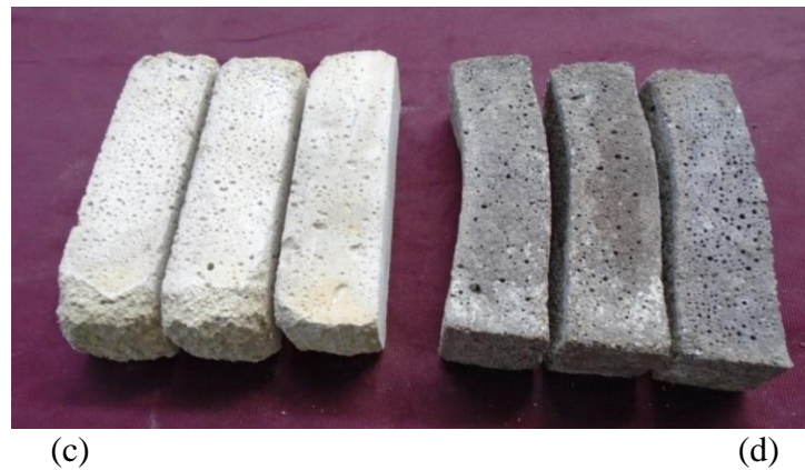
Figure IV. 11 : Etat des éprouvettes des mortiers : (c) NWM ; (d) LMEPVC75, à 850°C.
