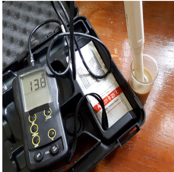
Figure IV.14. La mesure du pH et de la conductivité électrique du sol
