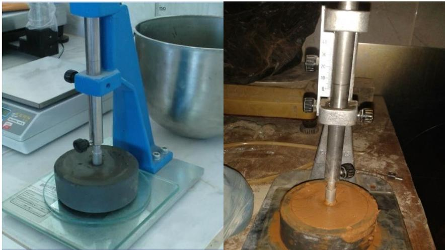
**Figure I.9: Essais de consistance normale sur pâte de ciment et pâte de vase calcinée**
