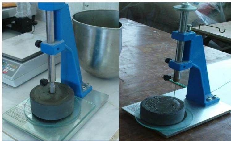
**Figure I.4: Essais de consistance normale et de prise par l'appareil de Vicat**
