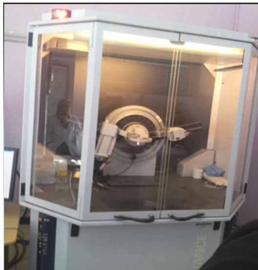
**Figure II.3: L'appareil de diffractomètre D8 Advance.**
