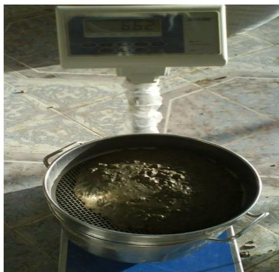
**Figure II.3: Aspect de l'essai de la stabilité au tamis**
