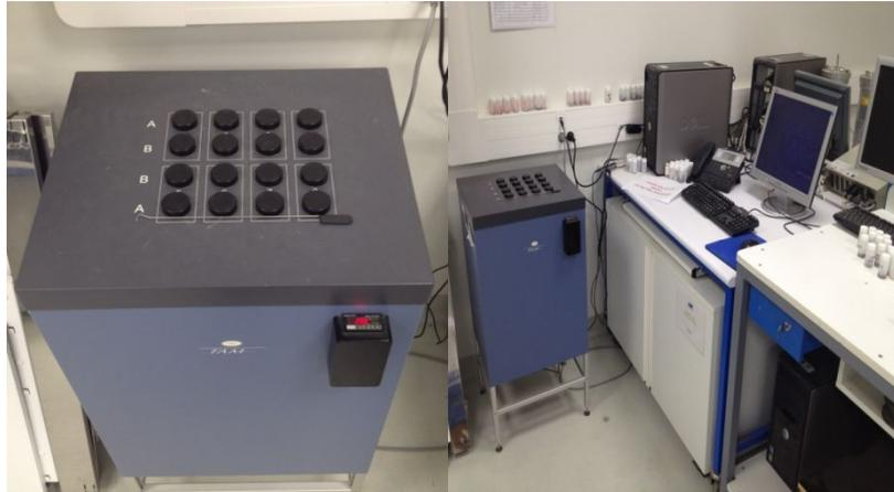
**Figure II.6: microcalorimètre isotherme multi-canal.**
