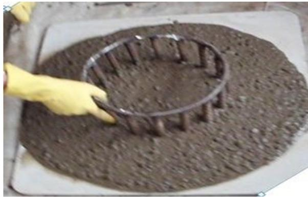
**Figure II.4: Aspect de l'essai J-Ring****e) Le ressuage**
