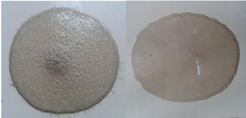
**Figure I.14: Galette obtenue à partir de la formulation basée sur la méthode d'équivalence par les surfaces des granulats**
