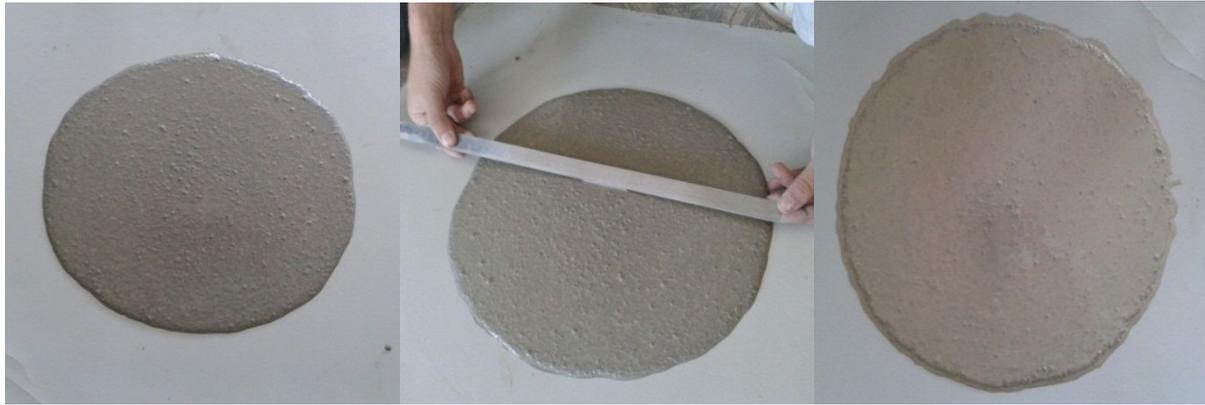
**Figure I.18: Etalement des MBE avec respectivement 0.7%, 1% et 1.3% de Sp**
