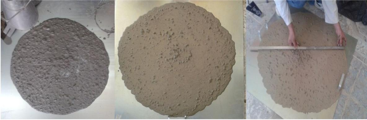
**Figure I.16: Etalement des BAP avec respectivement 0.7%, 1% et 1.3% de Sp**
