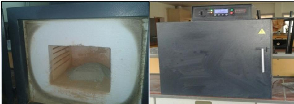
**Figure I.1: Four de calcination utilisé (+ 1200°C)**
