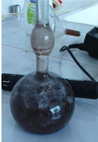
**Figure I.3: Pycnomètre de Le Chatelier.**
