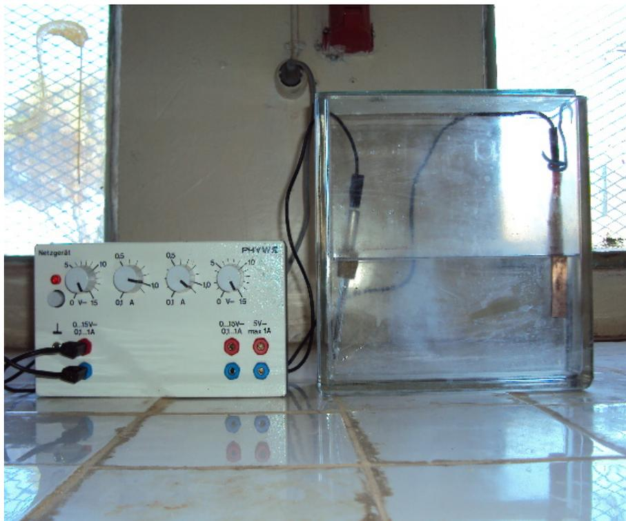
FIGURE IV.9 – Dispositif expérimentale de chargement électrolytique d'hydrogène à température ambiante
