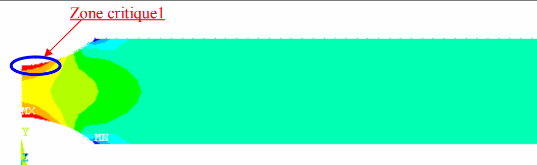
Figure III.11. Zone critique due au chargement en traction monotone
