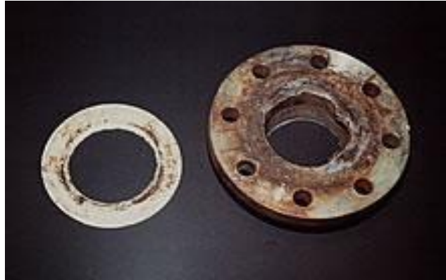
Figure II.7: La Corrosion caverneuse d'un acier allié sous un joint.
