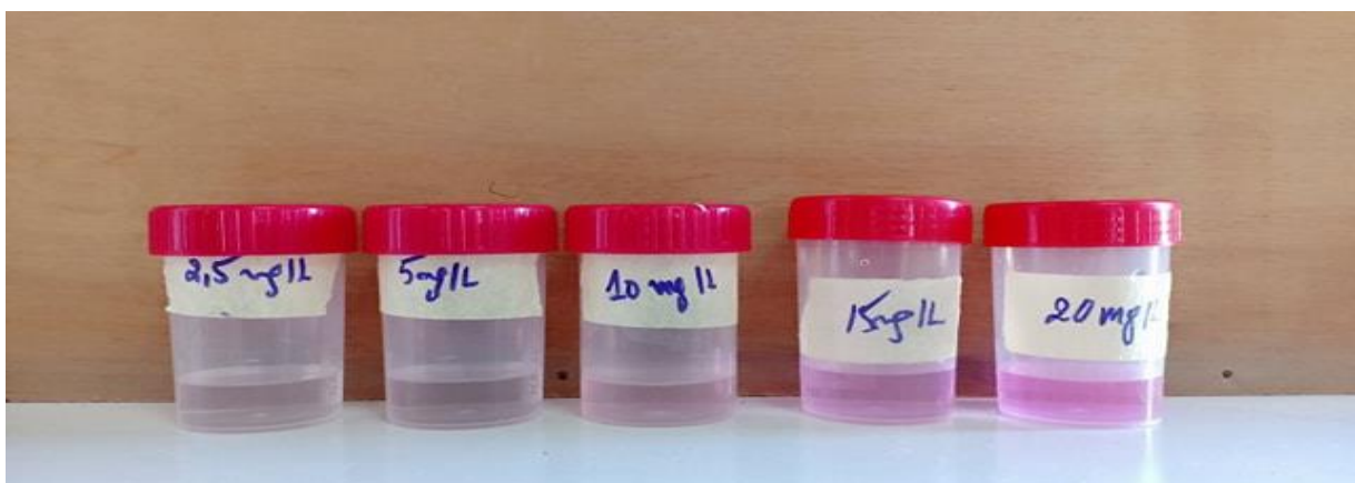
Figure II.16 : Effet de la concentration initiale du colorant sur la dégradation du Rh-B par le procédé UV/H600-5N
