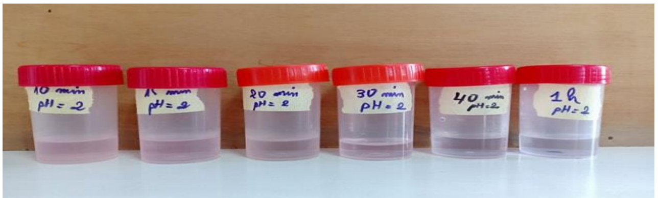
Figure II.14 : Photo représentant les échantillons traités en fonction du temps. A première vue, nous avons obtenu une décoloration totale de la solution de la Rh-B en présence de H600-5N au bout de 60 minutes (figure II.14).
