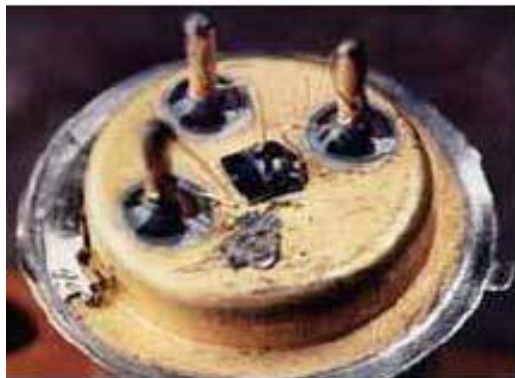
Figure I.1: Premier transistor MOSFET réalisé par M. Atalla, D. Kahng en 1959[4].
