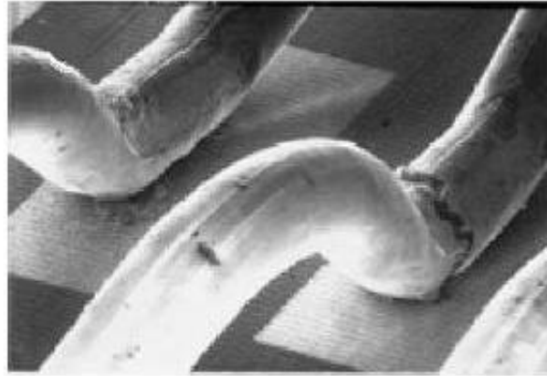
Figure II.12 Fissure au pied d'un fil de bonding [35]
