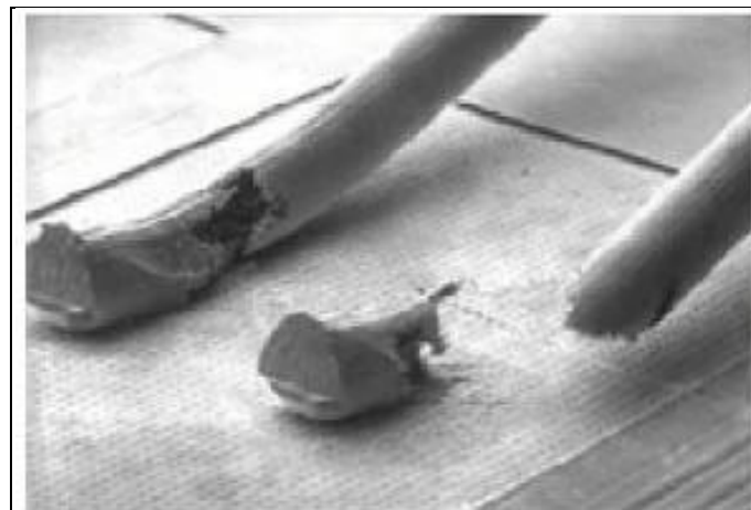
Figure II.16 Rupture d'un bonding d'émetteur due à la corrosion [20]
