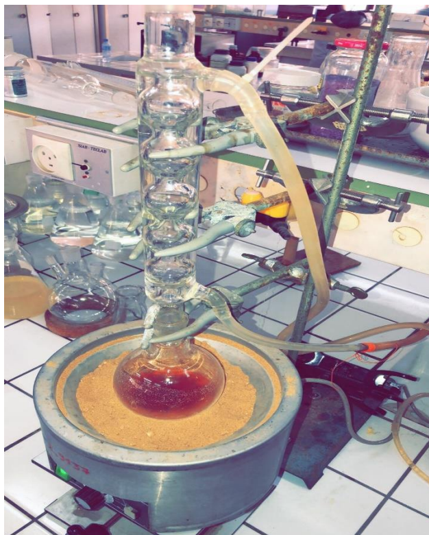
Figure II.4: Extraction de la lignine par montage reflux.
