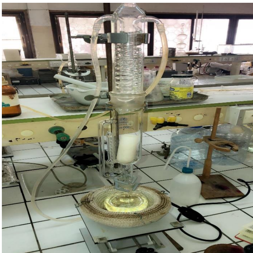
Figure II.2: Extraction par soxhlet
