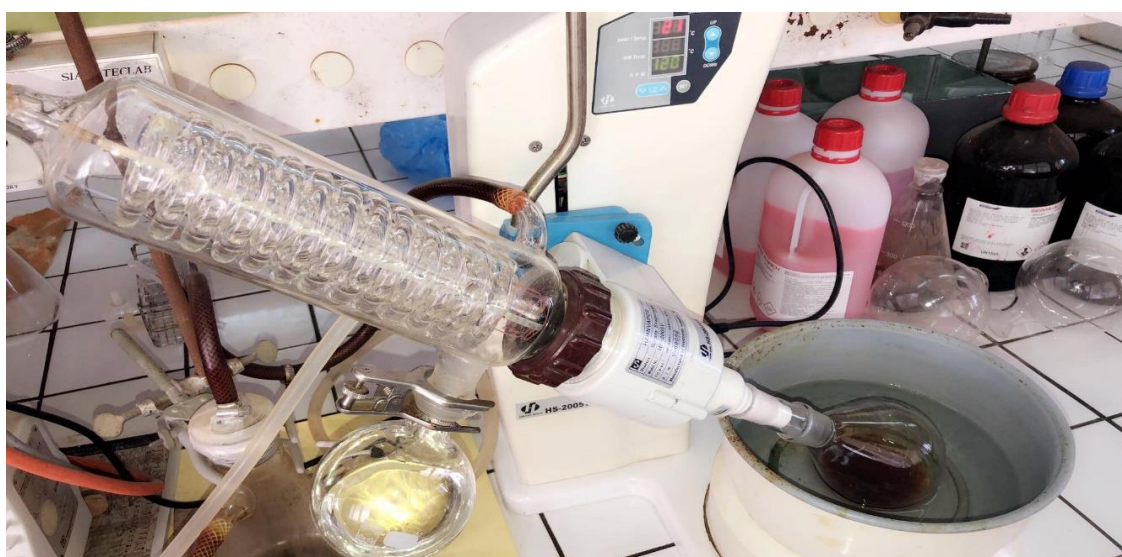
Figure II.5: Evaporation du solvant dans un rota- vapeur
