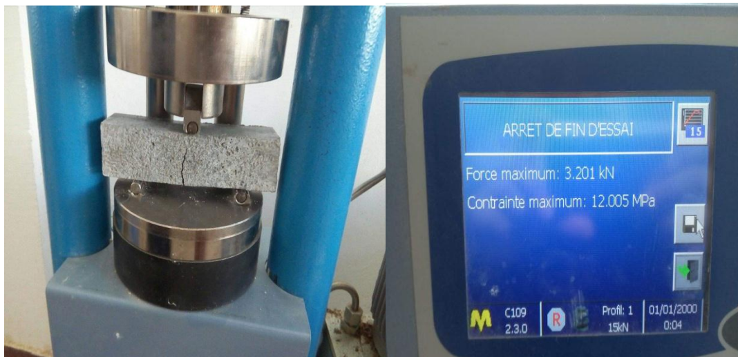
Figure 2.10 : l'état des résultats après l'essai de résistance à la flexion.
