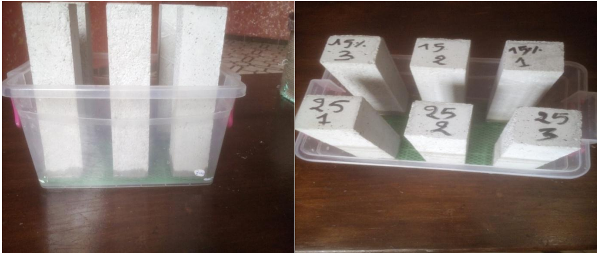
Figure 2.6: Eprouvettes dans le récipient en position verticale avec un niveau d'eau constant 3mm.
