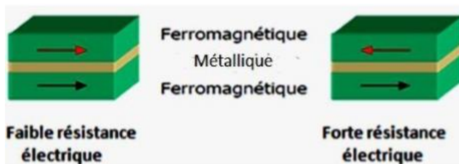
Figure I.11 : les deux états, parallèle et antiparallèle, dans une jonction géante magnétique.
