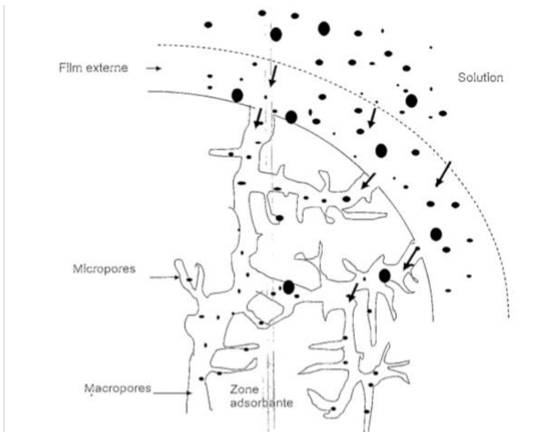
Figure I.2. Mécanisme d'adsorption sur une particule de charbon actif
