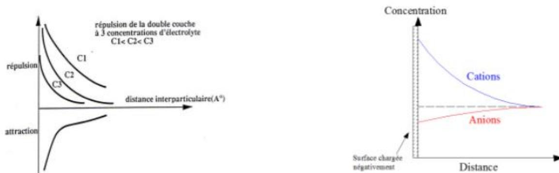
**Fig.II.13 :** Forces électrostatiques dans la double couche, Répartition des ions autour d'une particule chargée.
