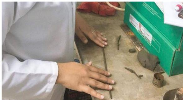
**Fig.VI.4** : Essai pour la détermination de la limite de plasticité
