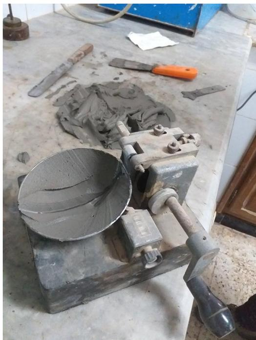
**Fig.VI.3:**Essai pour la détermination de la limite de liquidité.
