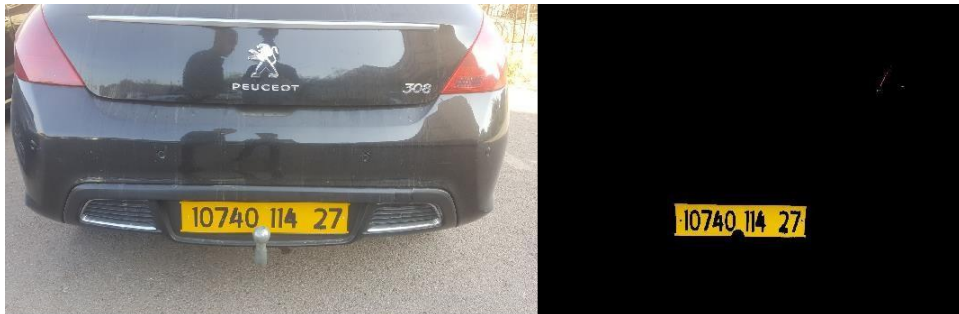
Figure III-4 : Détection de plaque d'immatriculation par couleur
