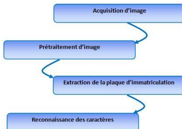
Figure 0-1 : Les 4 fonctions d'un système RAPI
