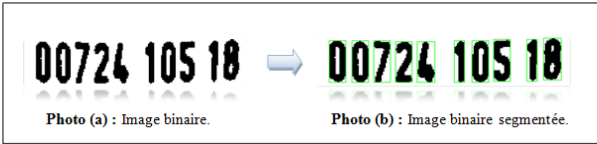
Segmentation des caractères d'une plaque d'immatriculation
