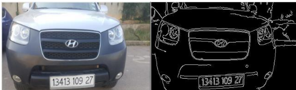
Figure III-5 : Détection de plaque d'immatriculation par contour
