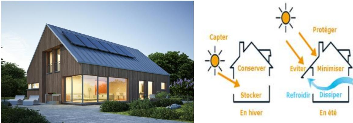
Figure I.2 : le principe de conception bioclimatique
