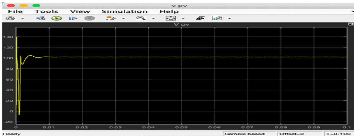
Figure III.29 Tension de sortie du générateur photovoltaïque en (V)
