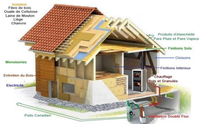
Figure I.8 : Matériaux de construction et leurs performances thermiques
