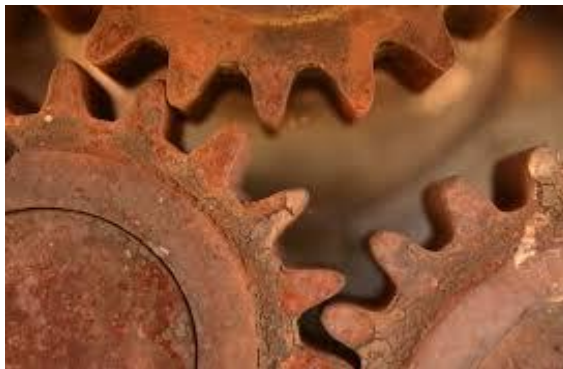
Figure 16 : Corrosion des engrenages.
