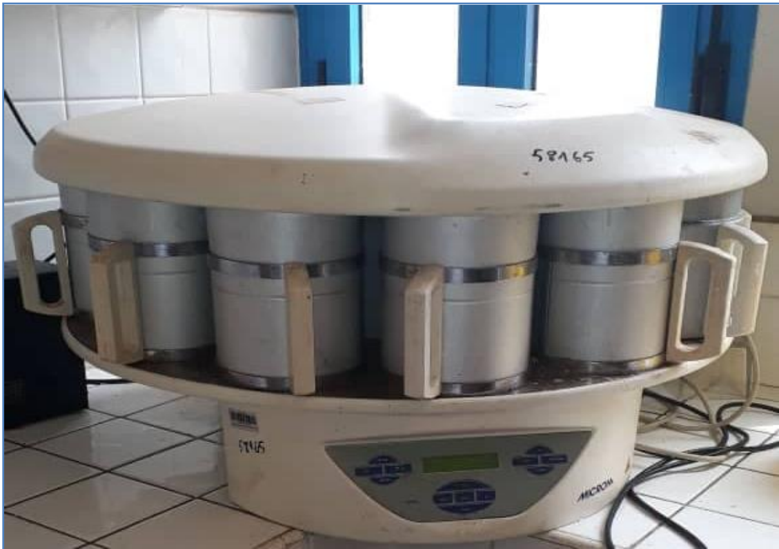
Figure (21) : Automate de déshydratation (CHU.2020).
