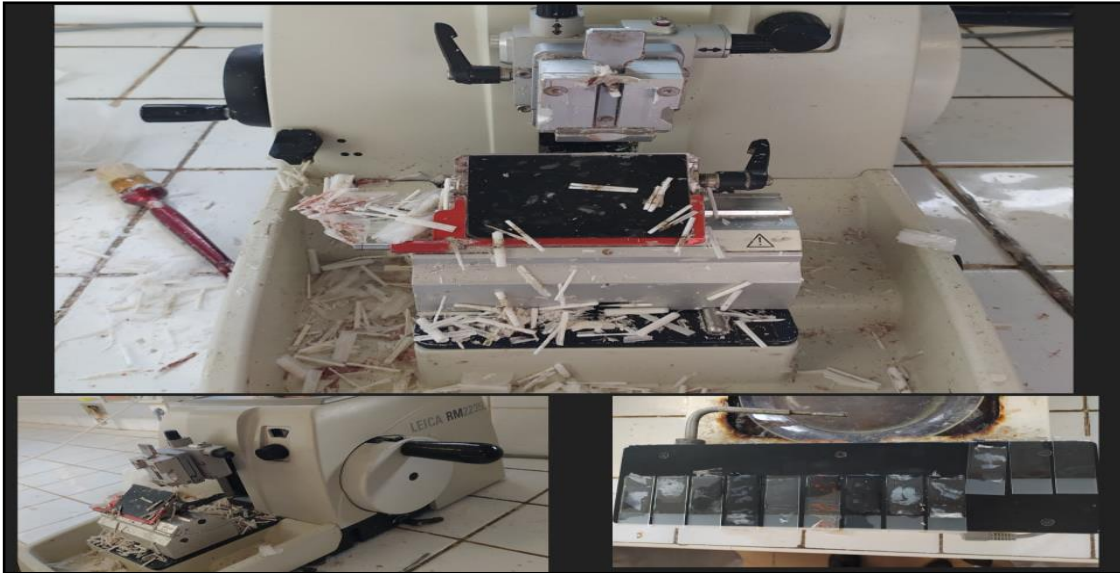
Figure(24) : la coupe au microtome manuel.
