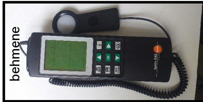
Figure 10 : un luxmètre (capteur photométrique)
