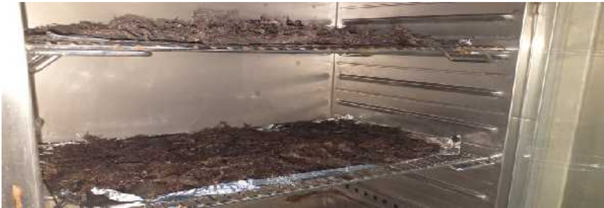
La matière végétale dans l'étuve pendant 24heures
