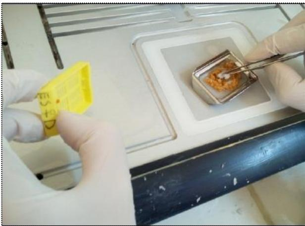
Figure 16 : Placer la pièce dans le moule.
