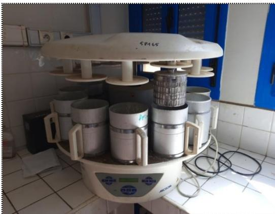
**Figure 14 :** Appareil déshydratation
