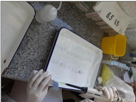
Figure 53 : Déposer les anticorps dans les lames d'immunohistochimie
