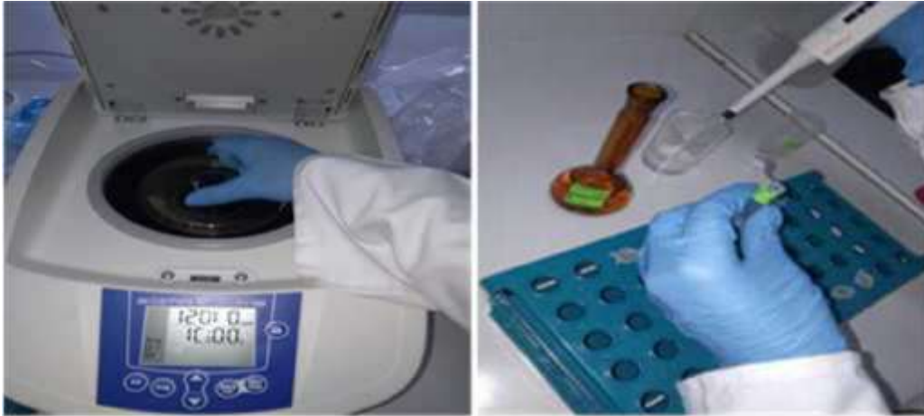
Figure 21 : Séparation des composés avec la centrifugation et élimination de surnageant et l'ajoute du fixateur.
