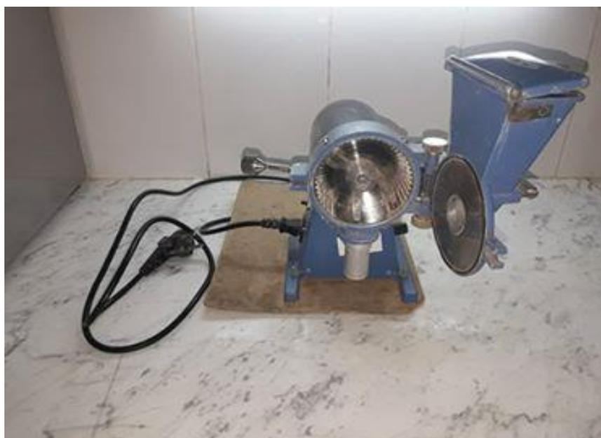
Photo 13 : Le micro-broyeur (IKA Culatti MFC Micro-Precision Beater Mill)
