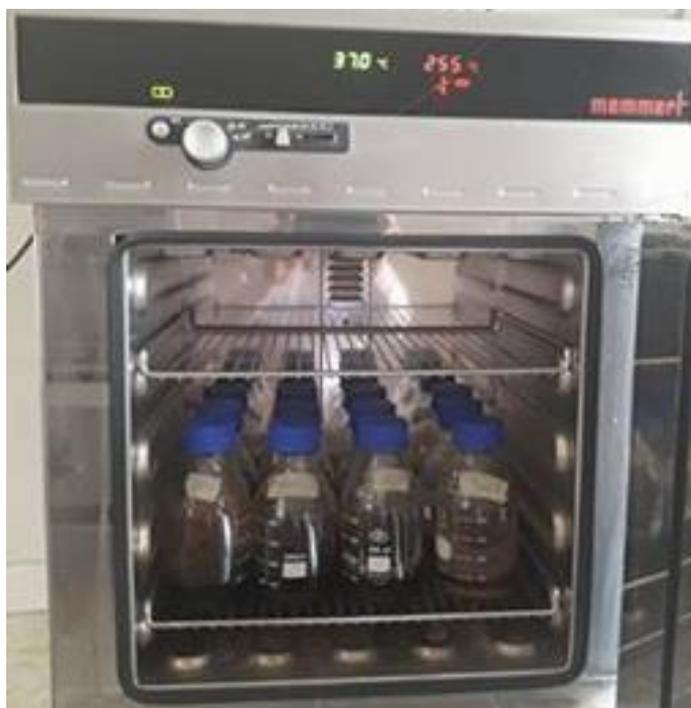
**Photo 14 : Prétraitement alcalin pour les digesteurs batchs**
