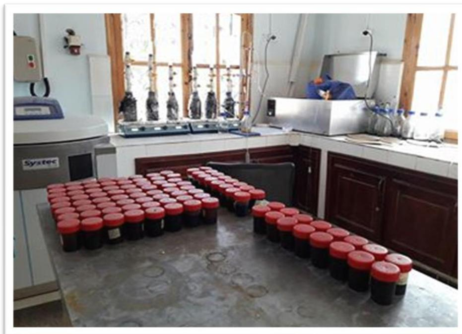
**Photo 15 : pots de prélèvement en plastique contenant les substrats prétraités et non traités pour alimentation des digesteurs en continus**
