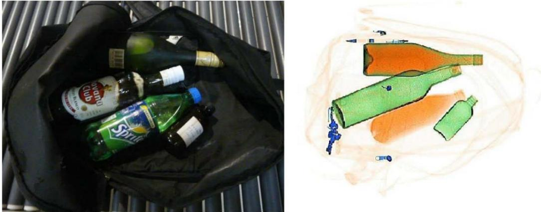
Figure 8 : une image fournie par un système de radiographie X-ray à double énergie se joint au bagage d'origine.
