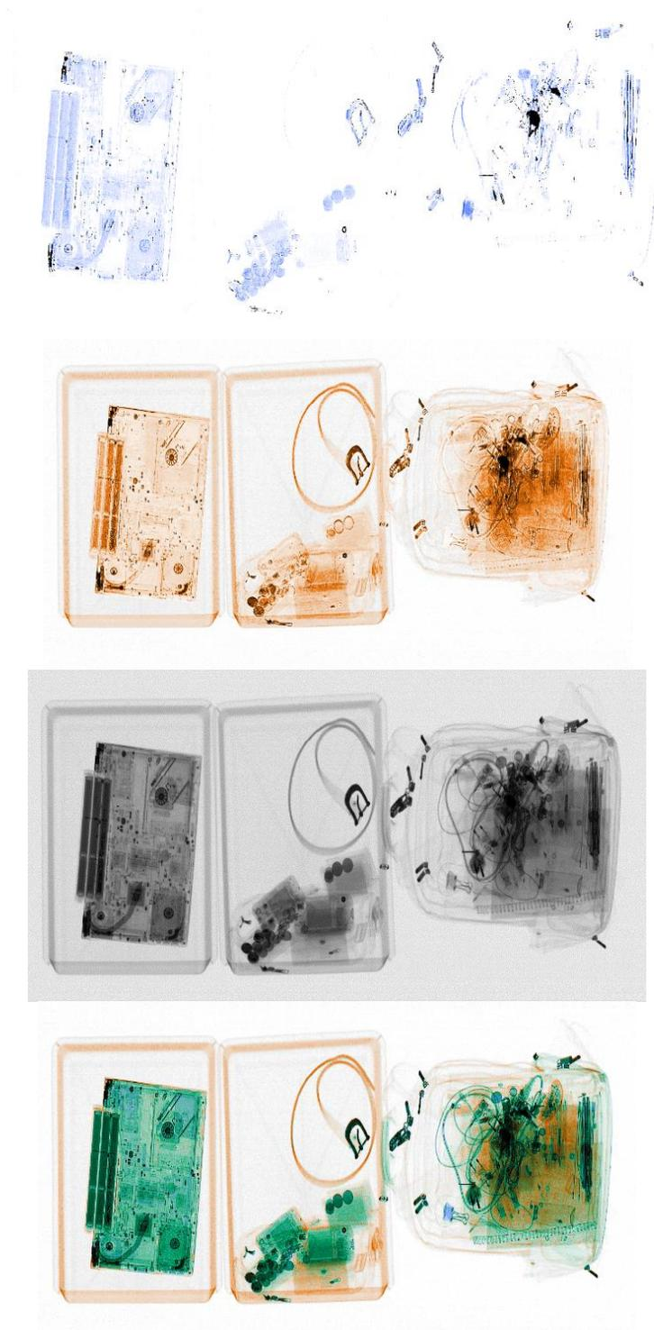
Figure 25: Les images radiologiques originales, ils représentent respectivement de haut au bas: image à basse énergie, image haute énergie, l'image en niveaux de gris, l'image fusionnée.
