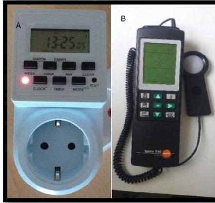
**Figure 66.**(A) : Minuteries numériques ; (B) : Luxmètre (capteur photométrique)
