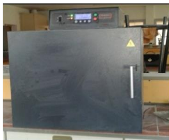
Figure IV .1.3.b: Four de calcination Utilisé (+ 1200°C).
