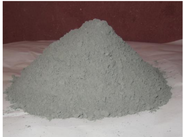
Figure II .1.2.3.b : Poudre de la perlite de Hammam Boghrara broyer à 80 µm
