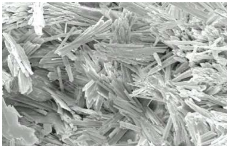
Figure II.7: Image (MEB) d'une microstructure du plâtre [15]
