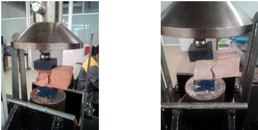
Figure V.8: Essai de compression sur le mortier du plâtre
