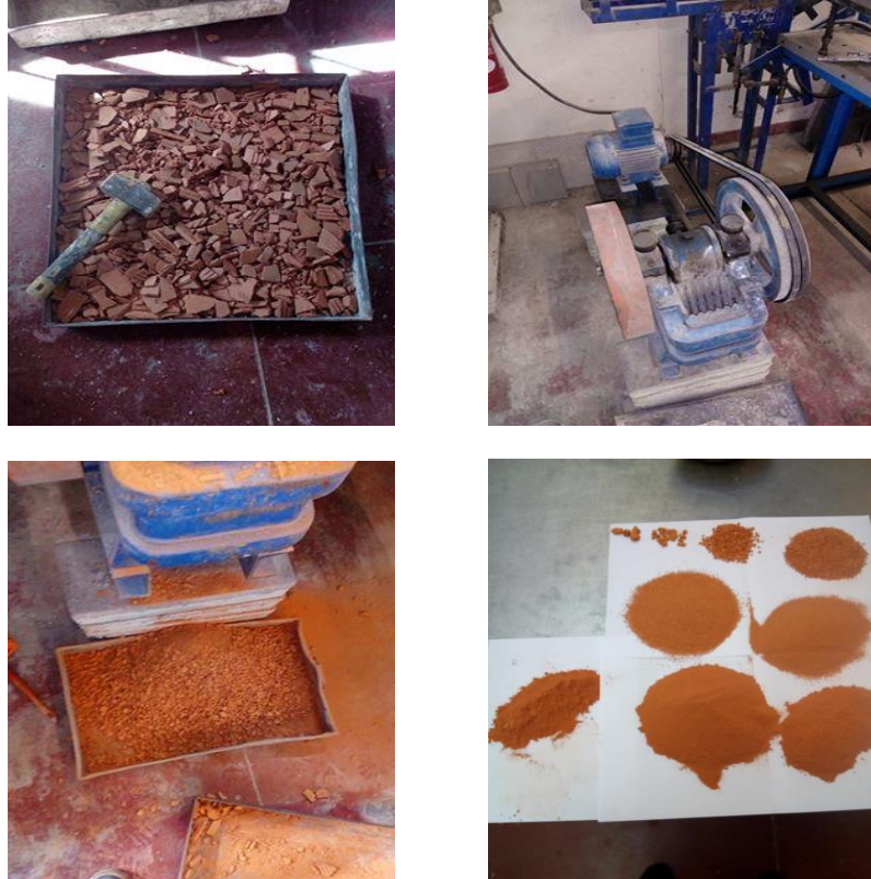
Figure IV.1: Equipements et méthode utilisés pour la préparation du sable à base de déchet de brique
