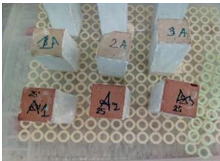
Figure IV.15 : Essai d'absorption par capillarité
