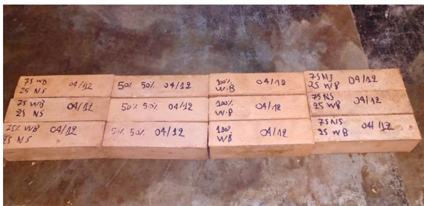
Figure IV.11: Eprouvettes de mortier après le démoulage.
