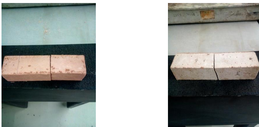
Figure V.6: Eprouvette soumise à l'essai de flexion.
