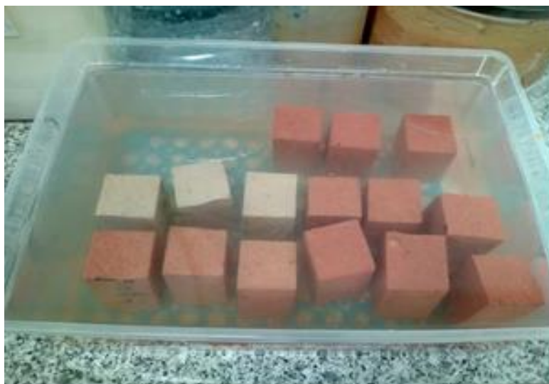
Figure IV.16: Essai d'absorption par immersion
