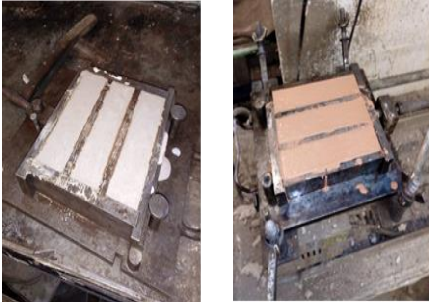
Figure IV.10: Mode de préparation des éprouvettes de mortier
