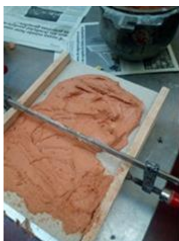
Figure IV.21: Pose du mortier sur les supports
