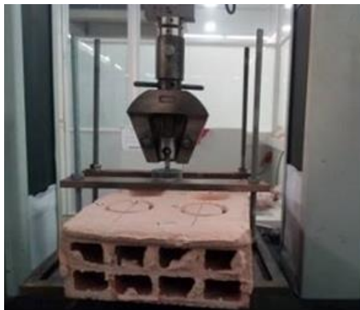
Figure IV.23: Dispositif d'essai d'adhésion
