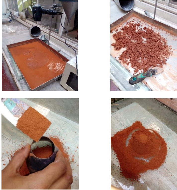
Figure IV.5: Absorption d'eau des granulats de sable
