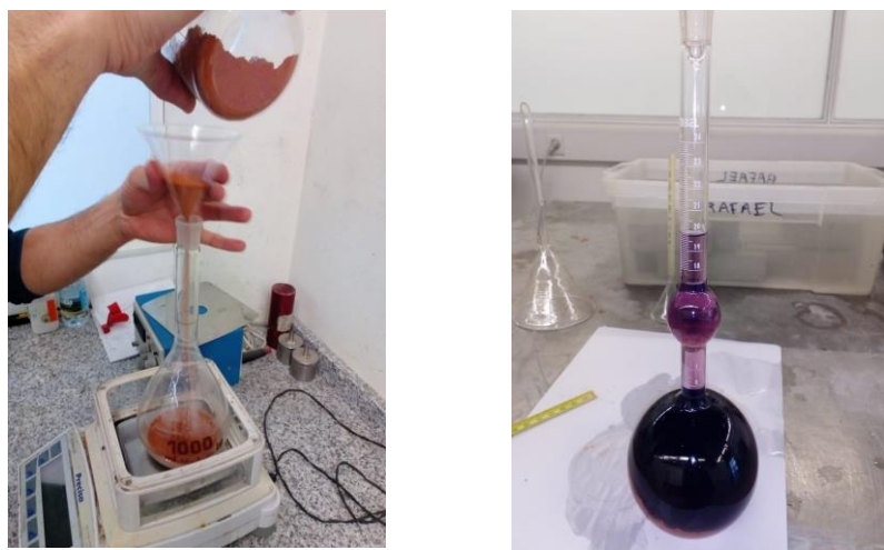
Figure IV.6: Absorption des grains par liquide de kérosène
