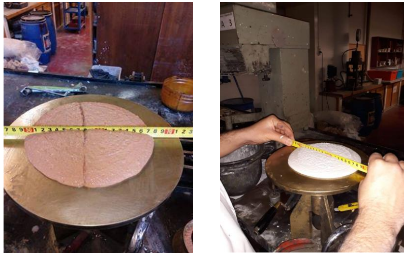
Figure IV.9: Essai de mesure de l'ouvrabilité.
