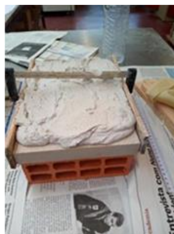
Figure IV.21: Pose du mortier sur les supports
