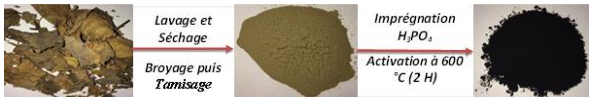
Figure III.4 : Etapes de préparation de charbon actif
