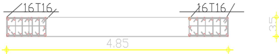
**Figure 66 :** ferrailage pour les voiles de longueur  $L=4.85\text{m}$  en zone d'about
