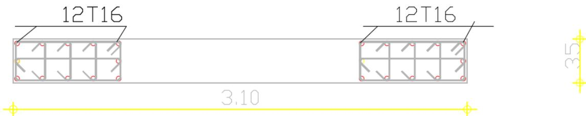
Figure 63 : ferrailage pour la voile de la cage d'escalier (voiles 3y) en zone d'about
