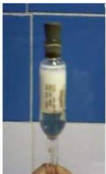
**Figure 02:** Butyromètre
