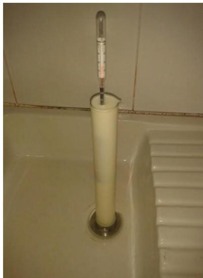
**Figure 03:** Mesure de la masse volumique par lactodensimètre
