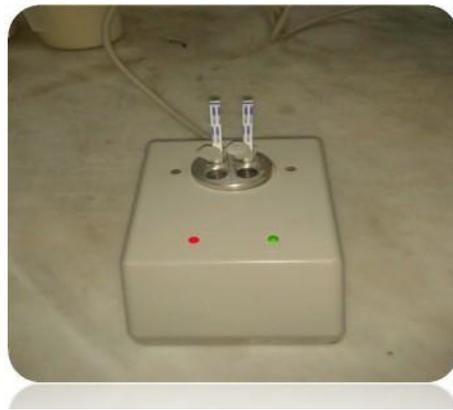
**Figure 04** : Appareil Beta Star 25
